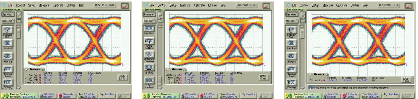
Eye Diagrams - 44 Gb/s - 1550 nm - From ModBox-1310nm-1550nm-44Gb/s-NRZ
