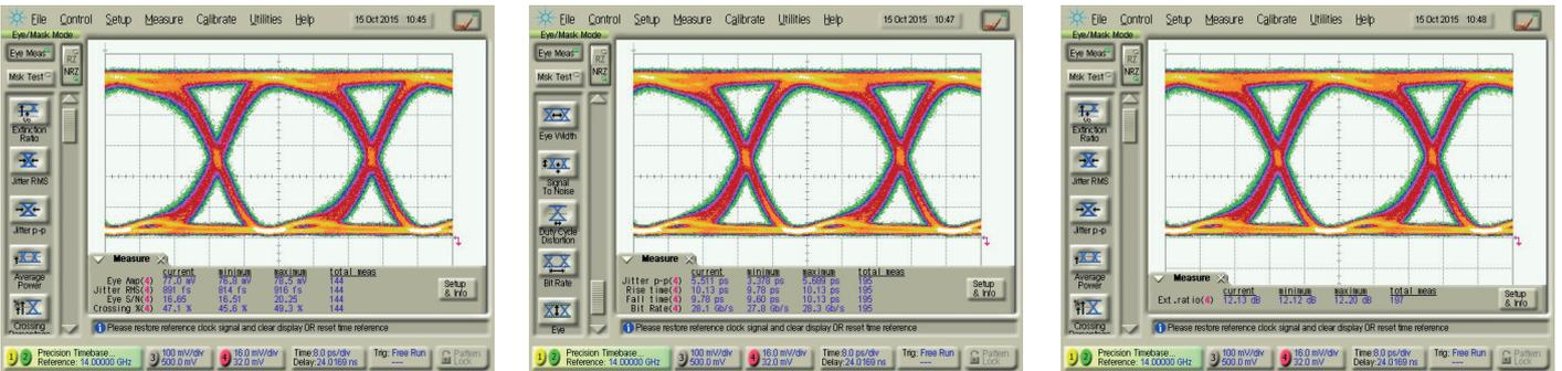
Eye Diagrams - 44 Gb/s - 1310 nm - From ModBox-1310nm-1550nm-44Gb/s-NRZ
